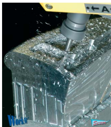
Fräsbearbeitung spielt im Flugzeugbau eine bedeutende Rolle. In vielen Fällen kommt zur Programmerstellung das CAM-System WorkNC zum Einsatz, das nach Unternehmensangaben hohe Qualität und Zuverlässigkeit garantiert.
