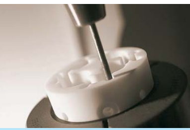
Keramische Bauteile mit der Ultrasonic-Technologie bearbeitet.
